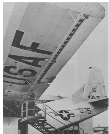
A la izquierda, el enorme depósito de herbicidas y la bomba de presión alojados en la bodega de carga de un Fairchild C-123 Provider de la USAF. A la derecha, las barras y picos de rociado dispuestos en las alas del avión. (USAF)
